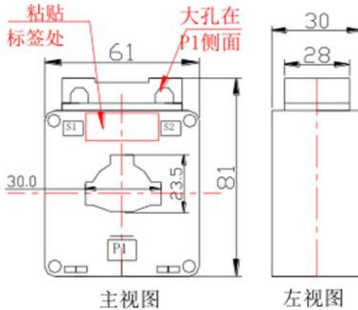
注：CT3025-200A/20mA、CT3025-100A/20mA 穿线孔径为：23mm，铜排孔径：30mm。
