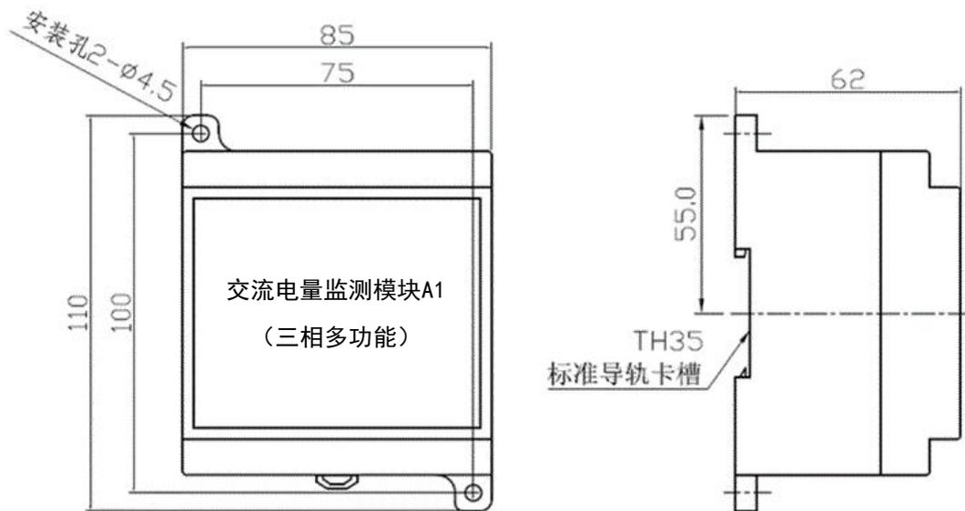
注：电量监测模块可采用导轨式或面板式两种安装方式。
